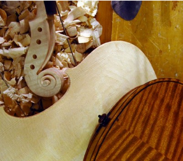
Hellinge skal forme fiolinens lokk og bunn, samt legge inn en tynn list som følger fiolinens omriss (Se fiolinens mørke omriss til høyre).
